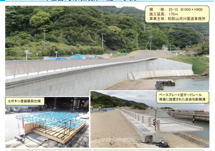
国道の4車線化に伴う工事において、歩道の確保が必要となり、アプロンⅡを採用して頂きました。その中で、海沿いの現場と言う事もあり、エポキシ塗装鉄筋を使用した塩害対策製品での採用となりました。また、アプロンⅡは右下写真の様に製品背面にガードレールや側溝の設置が可能な構造となっております。
